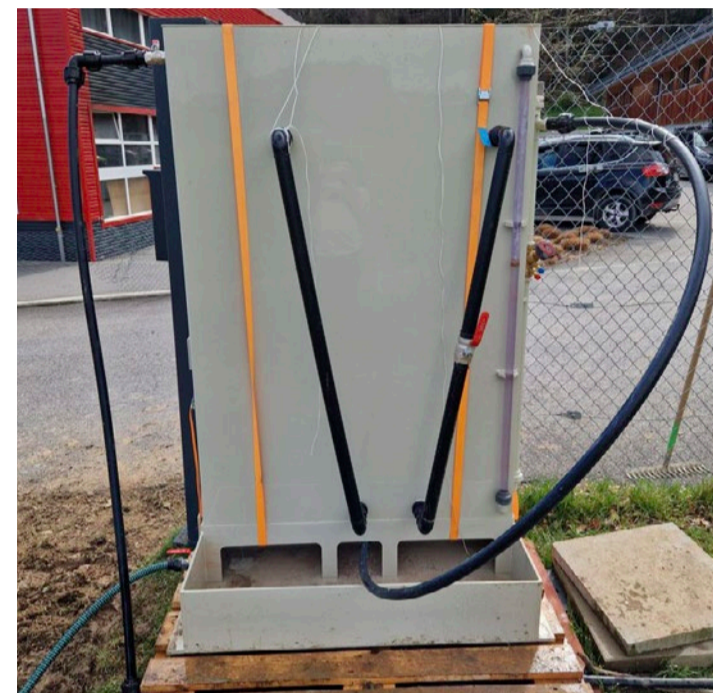
Le deuxième prototype du micro-KLS, monté sur une palette, était en phase de test cet été à Puidoux.
